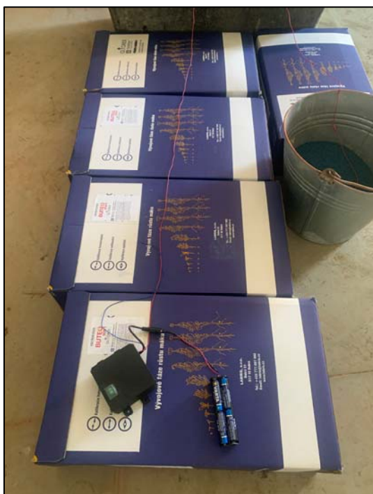
Obr. 3. Ošetření elektromagnetickými pulzními vlnami probíhá jen 30 minut pomocí vodiče a je možné ošetřit osivo rovnou v násypce secího stroje nebo přístroj připevnit natrvalo v sečce.
